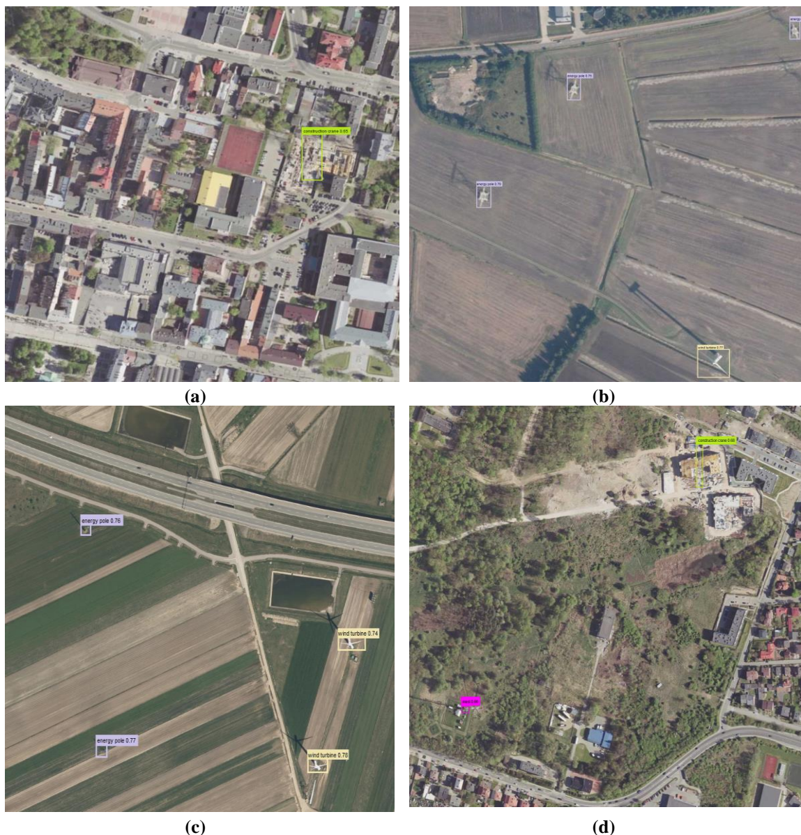
Rys. 23. Próbkę wykrytych obiektów dla kategorii: (a) dźwig budowlany, (b) turbina wiatrowa i słup energetyczny, (c) turbina wiatrowa i słup energetyczny, (d) dźwig budowlany i maszt [opr. wł.]
